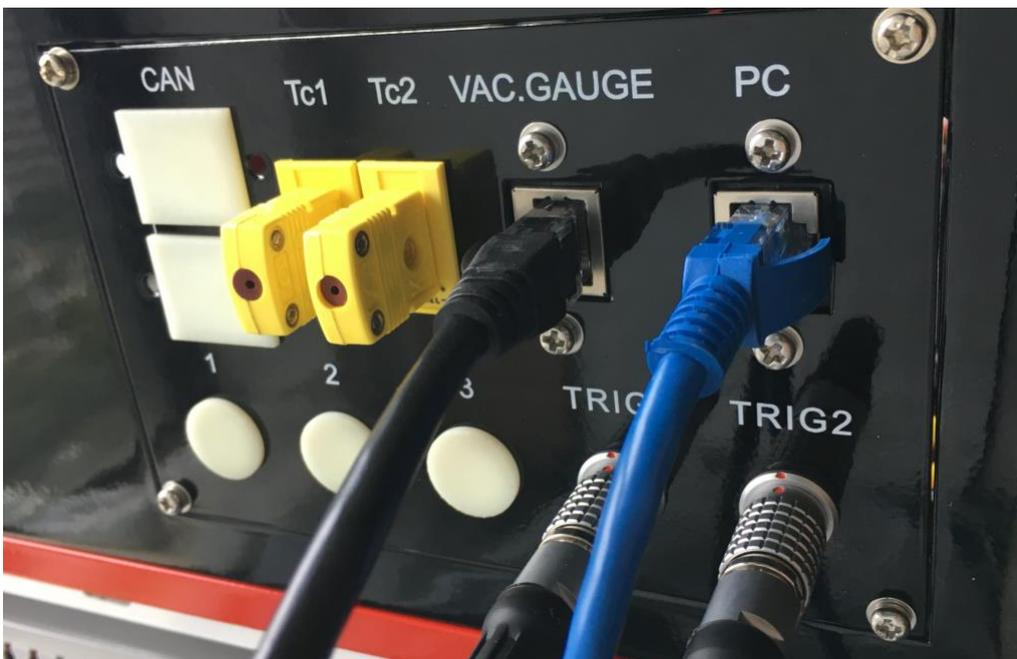
图 2-4 PC 口连接电脑网线端口
