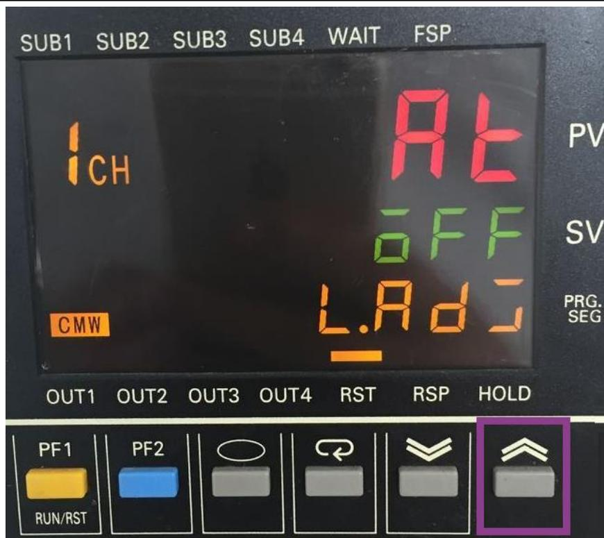
图 3-20 温度控制器自整定界面
