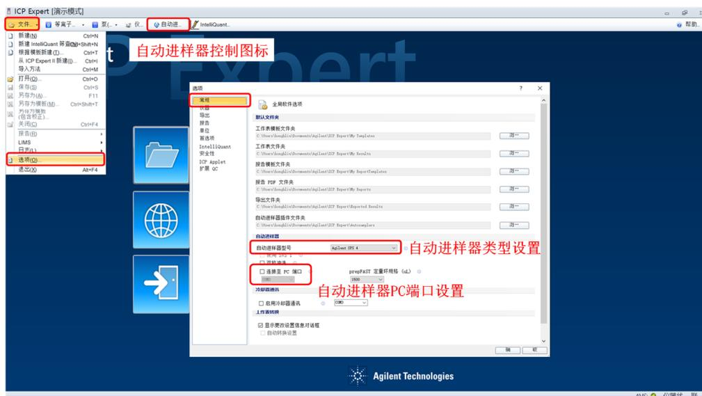
配置完成后可点击软件界面中的“自动进样器”图标
